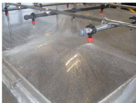
Foto 4: Campione sottoposto a prova durante il test di tenuta all'acqua
