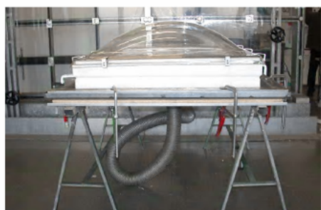
Foto 5: Campione sottoposto a prova durante il test di resistenza al carico verso l'alto (ignoring load)
